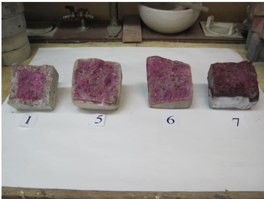
Рис. 4 Внешний вид образцов после испытаний на диффузионную проницаемость
