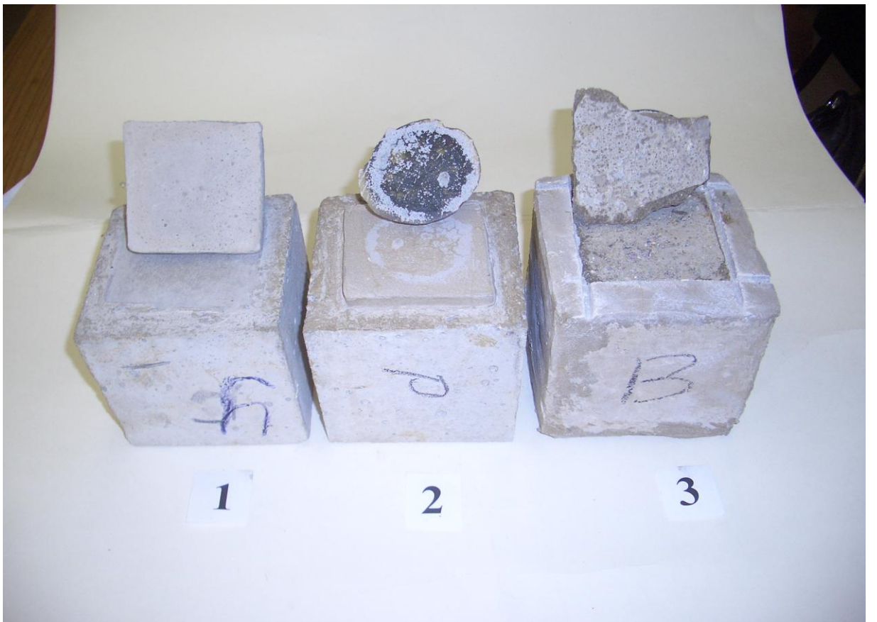
Рис. 6. внешний вид образцов до испытаний на адгезию
