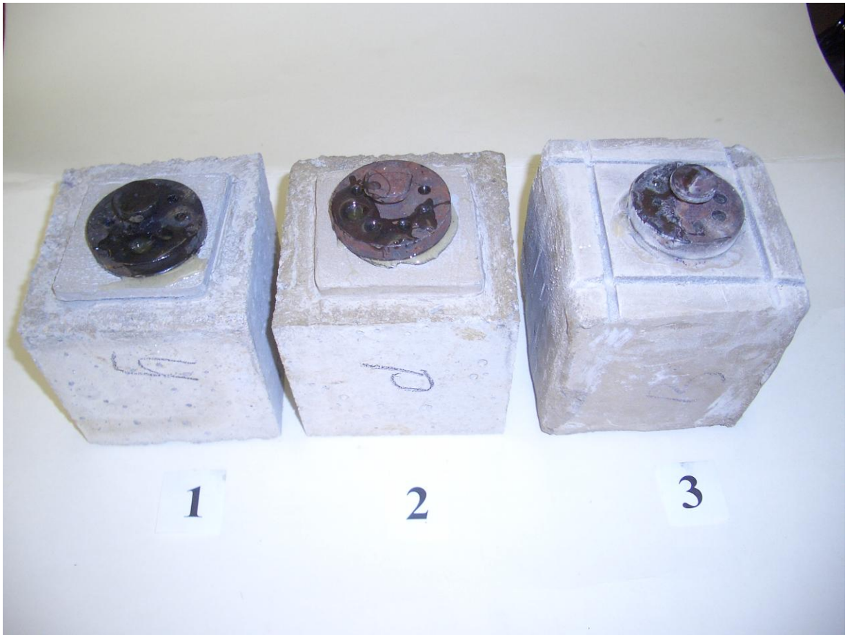
Рис. 6. внешний вид образцов до испытаний на адгезию
